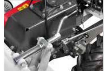
Regolazione altezza di taglio tramite manovella a vite senza fine. Finemente regolabile da 20 ad 80 mm.
