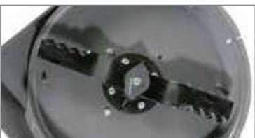
Lame di taglio rinforzate per intervenire in modo efficace anche su vegetazione consistente, roveti o sottobosco.
