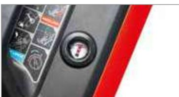
Indicatore di livello del carburante in una posizione visibile per consentire una rapida lettura del livello della benzina nel serbatoio.
