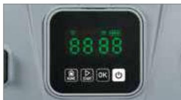
Grazie al display digitale a LED, è possibile sapere cosa sta facendo il robot e, seguendo le istruzioni per la risoluzione dei problemi contenute nell'APP, eliminare facilmente i guasti.
