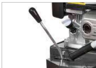
Comando selettore delle velocità con leva.
