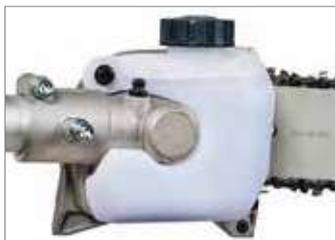
Il serbatoio semitrasparente permette la lettura del livello dell'olio necessario alla lubrificazione della catena senza rimuovere il tappo. La pompa dell'olio con mandata automatica è regolabile, permettendo di variare la portata dell'olio in funzione dell'utilizzo del tipo di legno.
