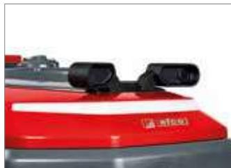
Rilevamento a ultrasuoni degli ostacoli per aumentare le prestazioni e la sicurezza del robot tagliaerba; il sensore (opzionale) può rilevare ostacoli di 10 cm di larghezza e 15-20 cm di altezza nella parte anteriore.
