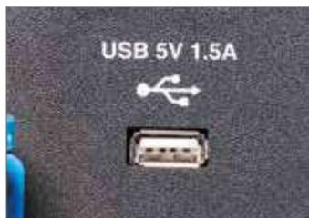
Uscita con presa USB per alimentare direttamente apparecchiature elettroniche.
