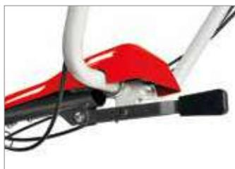
Stegole regolabili verticalmente ed orizzontalmente tramite una comoda leva a manubrio, permettono all'operatore di lavorare con una postura corretta.
