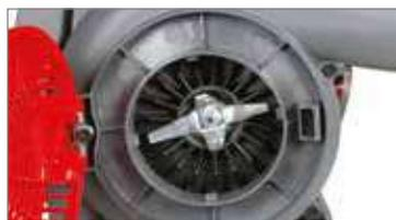
Coltello tritatore con 4 lame in acciaio di serie, che consente di ridurre al minimo il volume del raccolto all'interno del sacco (fino a 1/12 dell'originale), aumentando l'autonomia di lavoro.
