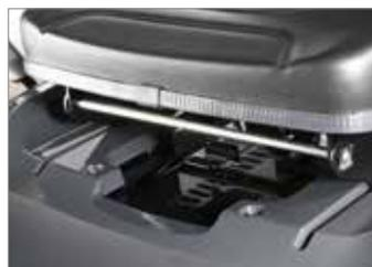
Posizione di guida confortevole, grazie al sedile registrabile direttamente dal posto di guida, permette una regolazione ottimale in funzione della statura dell'operatore (**95/16 K**).
