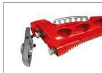
Versione DS 5500 BOSS: dotata di sistema antivibrante evoluto con fissaggio a 2 molle in acciaio che garantisce un'efficace riduzione delle vibrazioni percepite dall'operatore.
