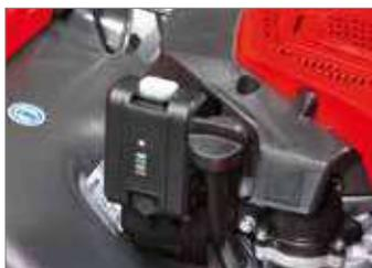
I modelli **TKE**, con motore Emak con avviamento elettrico a batteria ricaricabile, assicurano una partenza senza fatica. Il motore è dotato anche di avviamento a strappo.
