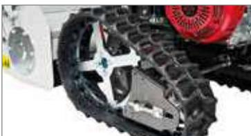
Sistema di trazione a cingoli, oscillanti si adattano alle varie tipologie di terreni (modelli **TR**).
