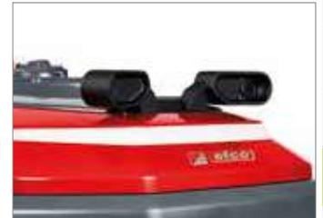
Rilevamento a ultrasuoni degli ostacoli per aumentare le prestazioni e la sicurezza del robot; il sensore (opzionale) può rilevare ostacoli di 10 cm di larghezza e 15-20 cm di altezza nella parte anteriore.
