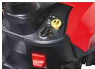
Le lame vengono azionate dall'operatore semplicemente premendo il pulsante di comando della frizione elettromagnetica posto sul cruscotto. Questo sistema garantisce inserimenti delle lame senza contraccolpi.
