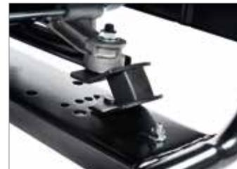
Motore posizionato su antivibranti in gomma per ridurre al minimo le vibrazioni durante il funzionamento.
