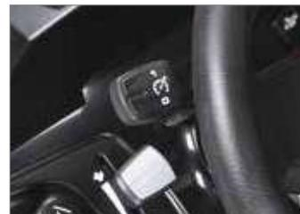
Il modello da **125** include di serie il cruise control che permette di impostare una velocità di avanzamento costante, ottimizzando in questo modo il tempo di lavoro.
