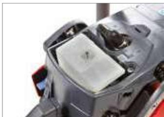
Filtro in nylon: grazie ad una elevata superficie filtrante aumenta le ore di autonomia di lavoro tra una pulizia del filtro e la successiva.
