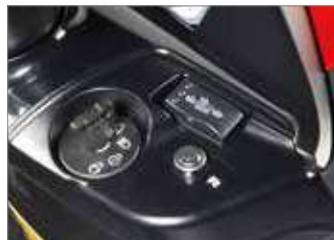
Le lame vengono azionate dall'operatore semplicemente premendo il pulsante di comando della frizione elettromagnetica posto sul cruscotto. Questo sistema garantisce inserimenti delle lame senza contraccolpi.
