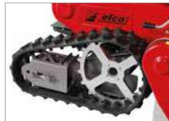
Sistema di trazione a cingoli, oscillante sul piano verticale (**80 TR, 100 TR**).
