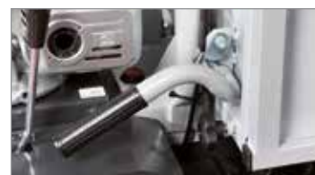
Ribaltamento manuale con sistema di bloccaggio automatico.
