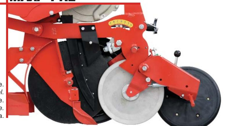
Leva di facile regolazione per le ruote di compressione, regolabili anche in larghezza.
