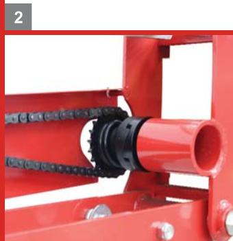
Organì di trasmissione a catena protetti da carter e dispositivo di sicurezza per ogni elemento.
