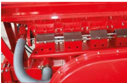
Dosatore seme Seed batcher Saatmischregler Dosateur graine Dosador de semilla
