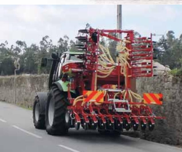
Chiusura idraulica a 2,55 di ingombro stradale
