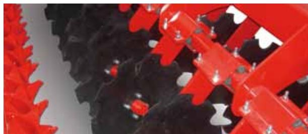
Ogni disco e' fissato con quattro elementi in gomma che proteggono i dischi.
