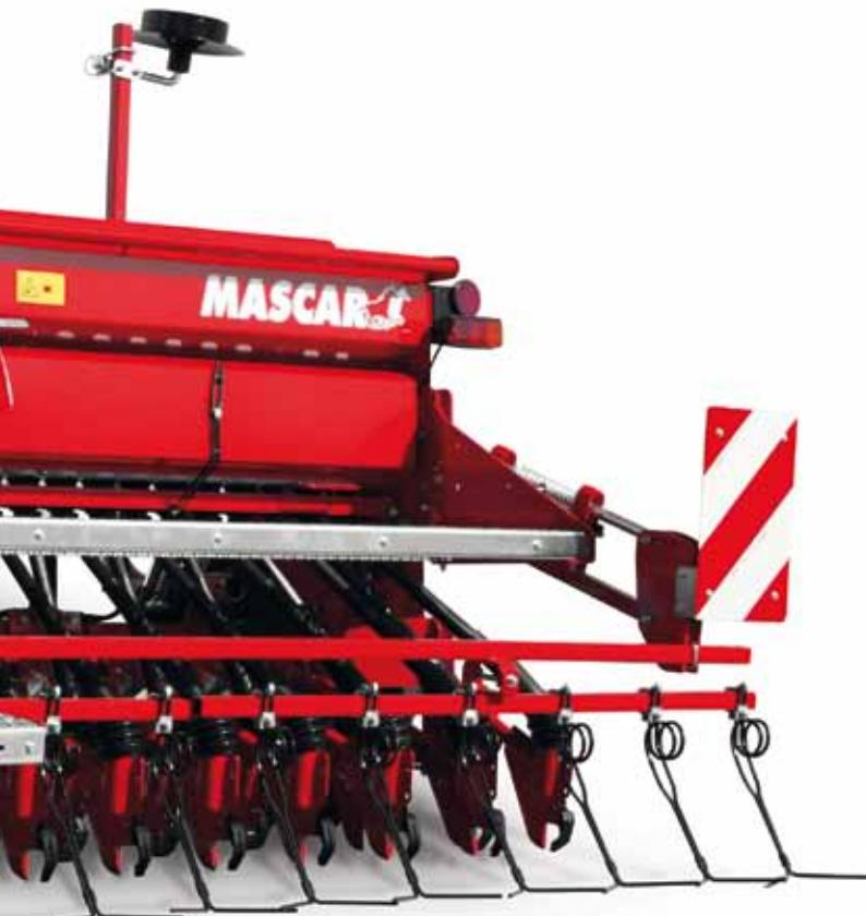
**DE** ARIZONA ist eine mechanische Sämaschine für Getreide und Feinsaat. Sie hat einen großvolumigen Saatkasten, um einen größeren Säbereich zu sichern. Perfekte und schnelle Saatdosierung dank eines stufenlosen Ölbadgetriebes. Die optimierte Form der Dosiernocken sichert eine perfekte Saatablage, gleichmäßig auf allen Reihen, auch auf sehr abschüssigen Feldern. Verfügbar mit Stiel-, Schlepp- und Doppelscheibenscharren.
