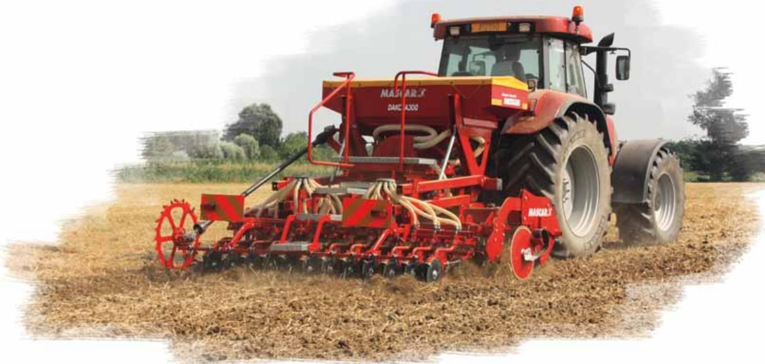
**DE** Säkombination. Mechanische Aufbausämaschine. DAKOTA ist mit einer unabhängigen Scheibenegge und Rollpacker kombiniert.
