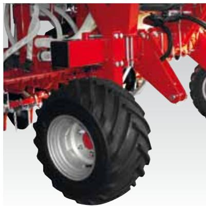
Ruote di trasmissione da 26.00-12 con carreggiata variabile
